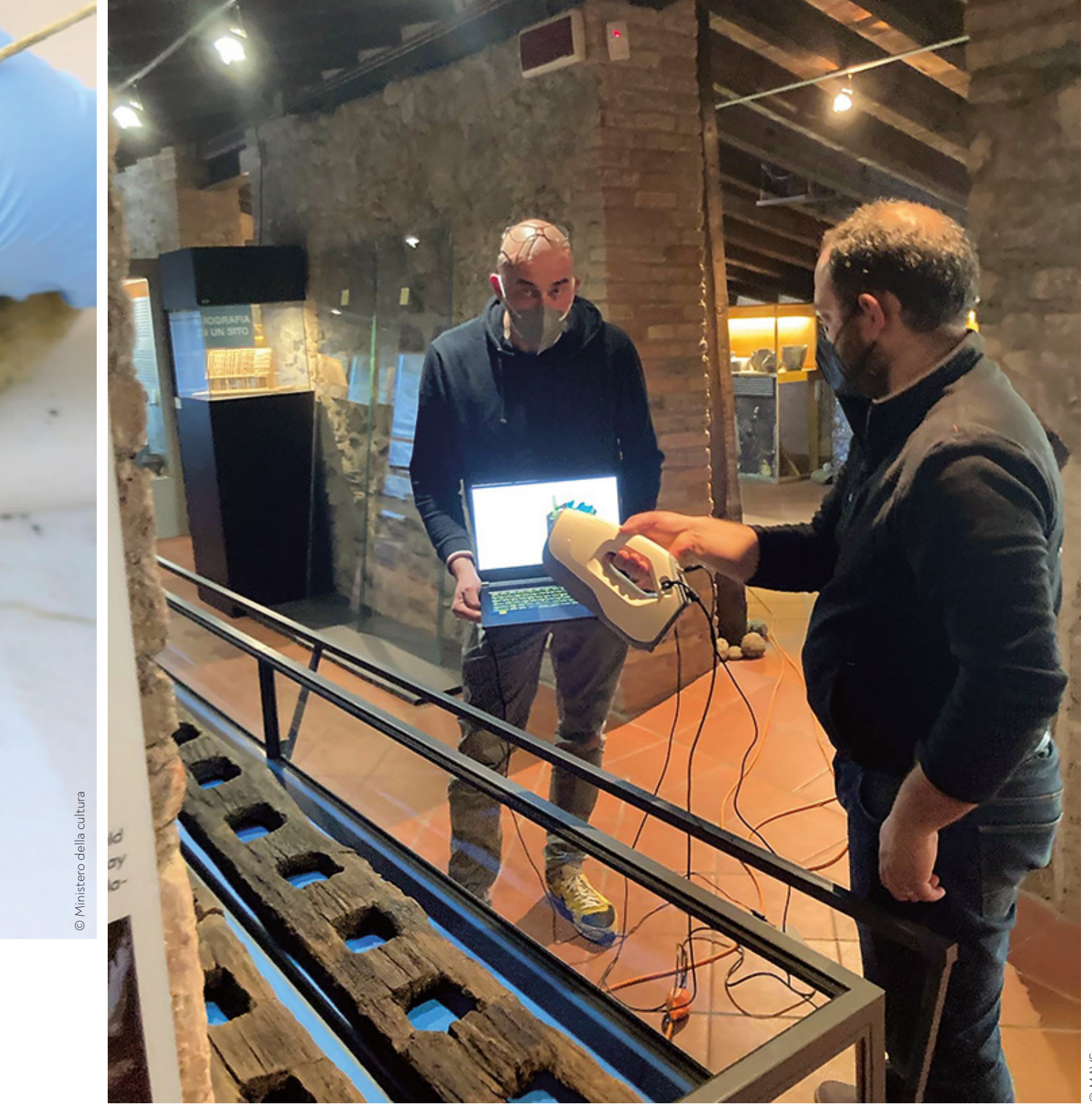
Documentazione 3D di una trave multiforata. 3D documentation of a multi-hole beam.
