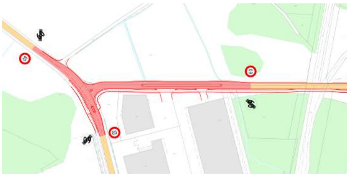
Abbildung 6: Signalisationskonzept, Teil West
